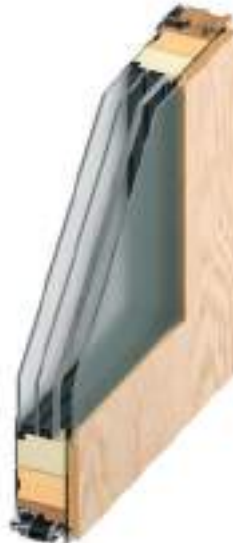
TRIPLE VITRAGE EN OPTION Triple vitrage retardateur d'effraction dépoli (4/20/4/20/TBE 10P5 avec intercalaire Warm edge)
