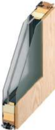
DOUBLE VITRAGE Double vitrage retardateur d'effraction dépoli (4/20/TBE 10P5 avec intercalaire Warm edge)
