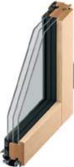
TRIPLE VITRAGE 87 mm Vitrage collé au cadre bois. Triple vitrage retardateur d'effraction dépoli (4/18/4/18/4 TBE 10P5 avec intercalaire Warm edge)
