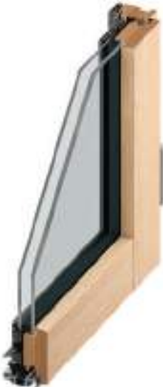
DOUBLE VITRAGE Vitrage collé au cadre bois. Double vitrage retardateur d'effraction dépoli (4/18/4 TBE 10P5 avec intercalaire Warm edge)
